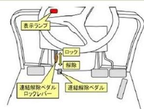
常時は連結され、必要な時にだけ連結を解除して片ブレーキとなる装置
